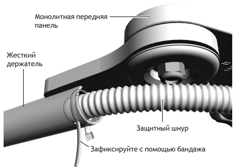
Рисунок 43. Проведение пучков трубок через защитный шнур
