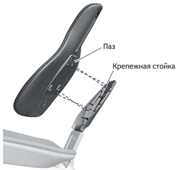
Рисунок 95. Установка обшивки спинки
