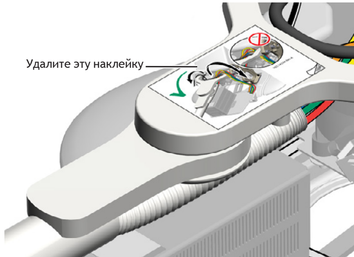
Рисунок 66. Удаление наклейки с инструкциями о прокладке проводов
