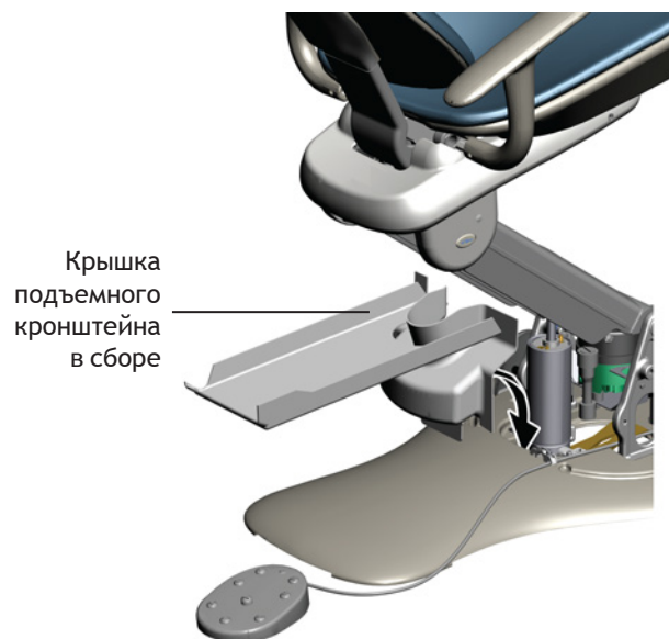
Рисунок 147. Установка сборки крышек подъемного кронштейна
