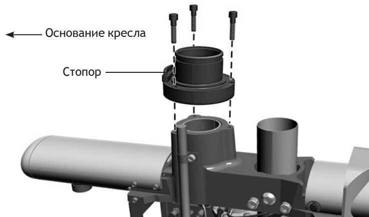
Рисунок 29. Установка узла телескопического кронштейна
