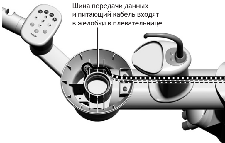
Рисунок 25. Прокладка соединений, вид на сенсорную панель сверху
