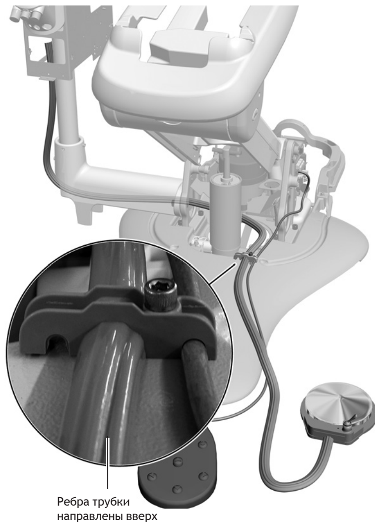
Рисунок 90. Закрепление трубок педали управления
