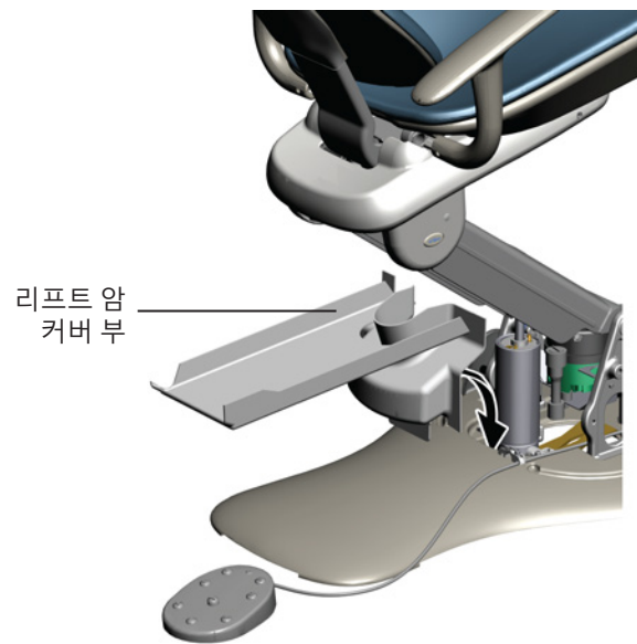
그림 147. 리프트 암 커버 부 설치
