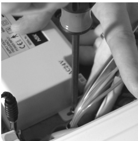
Figura 12. Montare il modulo di controllo
