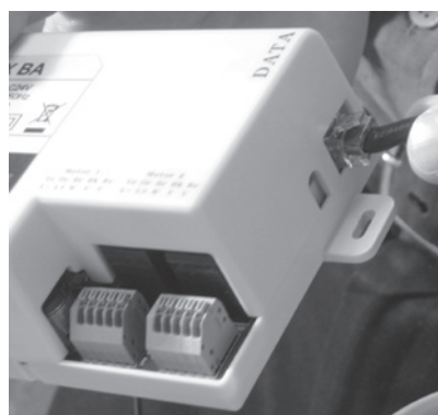
Figura 24. Collegare il cavo dati
