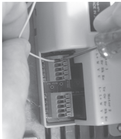
Figura 28. Collegare i cavi del motore del manipolo
