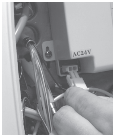
Figura 13. Collegare l'alimentazione CA
