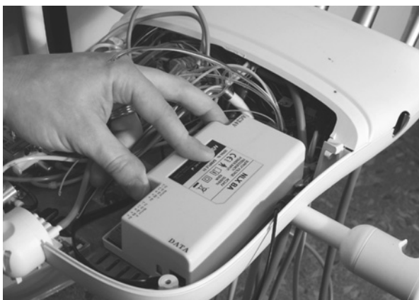
Figura 11. Posizionare il modulo di controllo nella faretra
