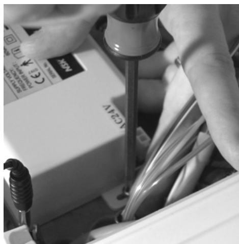
Figura 26. Montare il modulo di controllo
