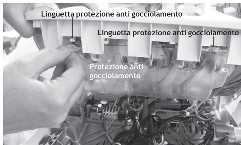
Figura 5. Tirare la protezione anti gocciolamento verso il basso
