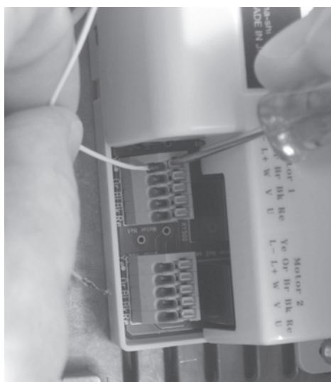
Figura 14. Collegare i cavi del motore del manipolo
