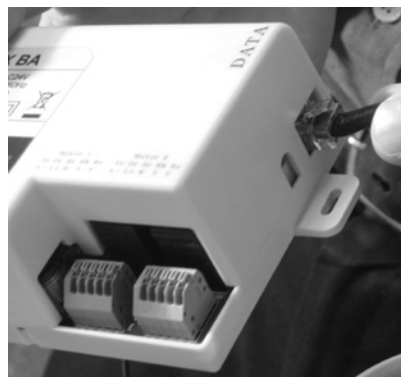
Figura 10. Collegare il cavo dati
