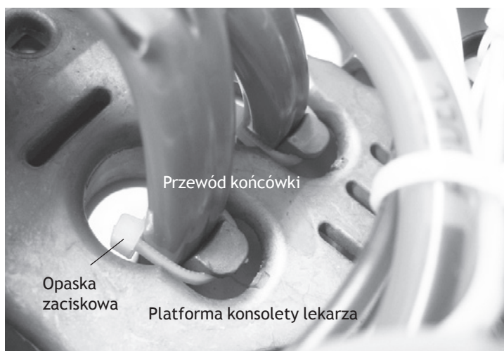
Rysunek 3. Instalacja przewodów w unicie Traditional
