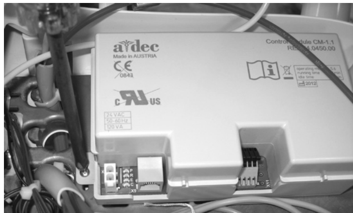
Rysunek 28. Mocowanie modułu sterowania
