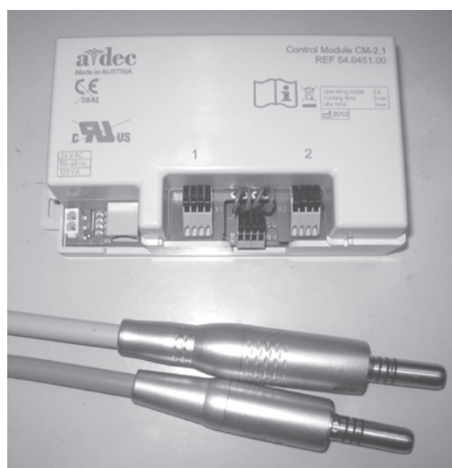
Rysunek 1. Moduł sterowania CM-2.1 z silnikiem elektrycznym A-dec EA-30 i/lub EA-52LED
