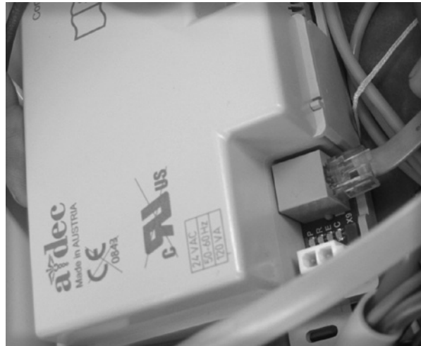
Rysunek 26. Podłączenie przewodu transmisji danych (DCS)
