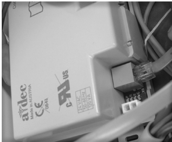
Rysunek 9. Podłączanie przewodu transmisji danych (DCS)
