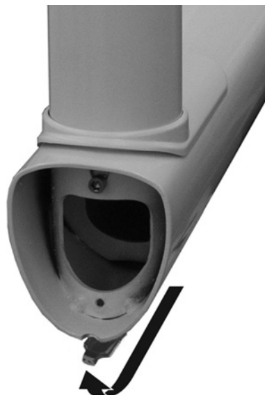
Rysunek 89. Instalowanie przewodu wyłącznika
