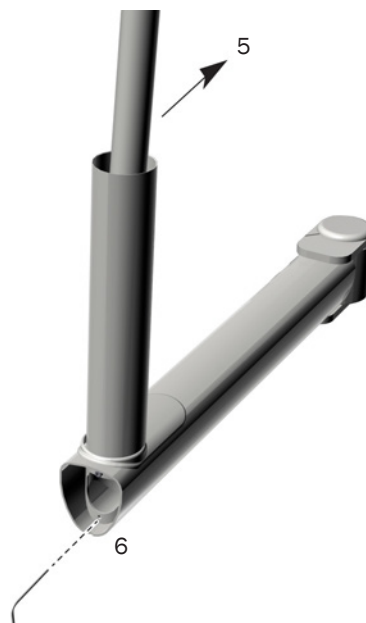
Rysunek 84. Mocowanie drążka lampy
