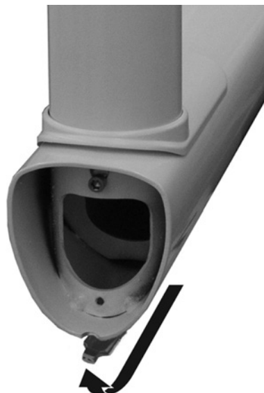
Obrázek 89. Instalace hadičky omezovacího spínače
