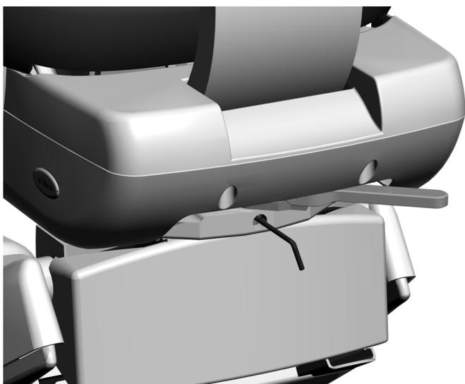
**2** Utilizzare una chiave a brugola per regolare la tensione del fermo di rotazione. Per aumentare la tensione, girare in senso orario. Una piccola regolazione aumenta o diminuisce significativamente la tensione.
