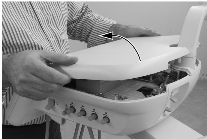
**3** Retirer la protection avant de la tête de contrôle.
