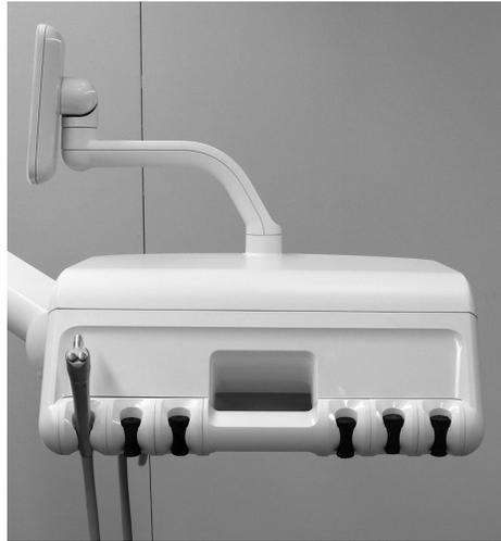
**2** Appuyer vers le haut sur le bouton d'ouverture de la protection à l'arrière de la tête de contrôle, et soulever la protection supérieure de la tête de contrôle.
