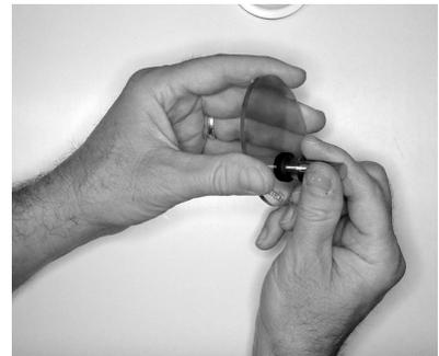
**4** Insérer le guide optique dans la lampe à polymériser et pousser le guide jusqu'à entendre un clic.
