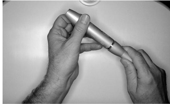
**3** Glisser la gaine de protection dans le guide optique par le haut, jusqu'à ce que le joint en caoutchouc repose sur la virole.
