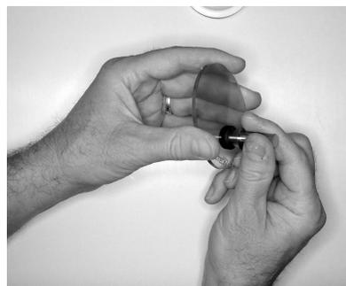
**4** Вставьте световод в полимеризационную лампу и надавите на световод до щелчка.
