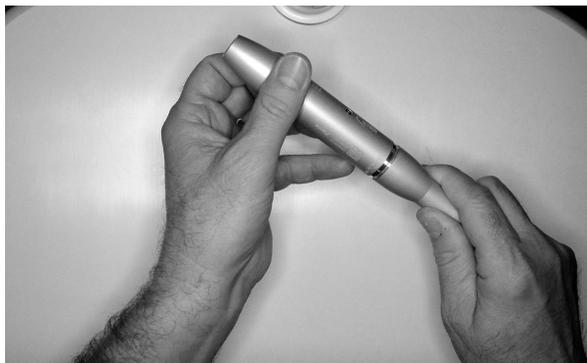
**3** Проведите защитный экран по световоду, надев резиновый уплотнитель на металлическую муфту.
