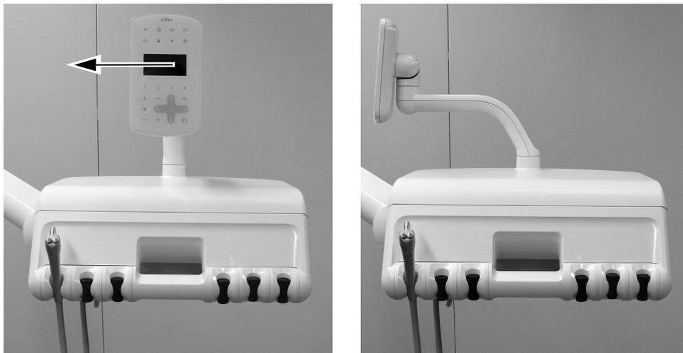
**2** Нажмите на затвор крышки с обратной стороны головного блока снизу вверх и снимите верхнюю крышку головного блока.
