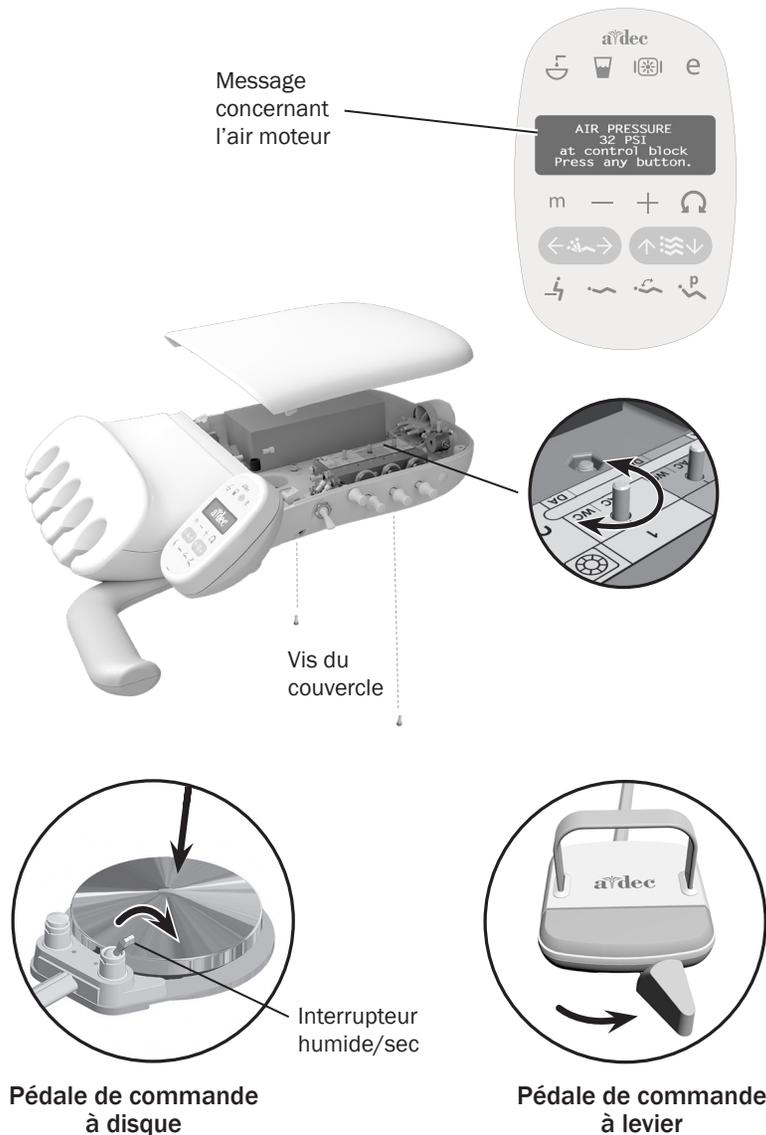
Il est possible de vérifier la pression de l'air moteur sur l'écran du clavier Deluxe en appuyant simultanément sur **—** et **+**. Pour les unités munies d'un clavier standard, et pour obtenir la mesure la plus précise possible, relier un contrôleur de pression (réf. A-dec 50.0271.00) aux cordons de l'instrument.
