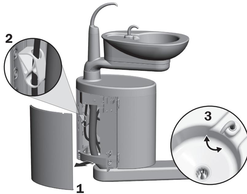
La fonction de rinçage du bol doit fournir assez d'eau pour pouvoir rincer entièrement le bol du crachoir. Si le débit n'est pas suffisant, il est possible de le régler au niveau du support central :
